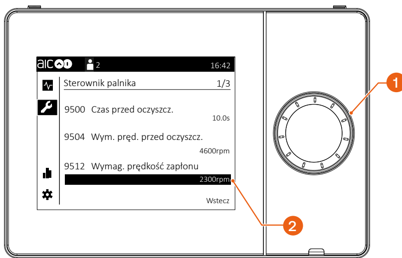
Rys. 19. Przykładowy ekran regulacji prędkości wentylatora
